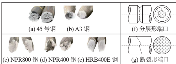
图 4 不同钢筋拉伸失效后断口对比及简要分类
